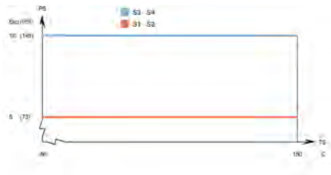
Диаграмма "давление–температура" для модели СВН16 (соответствует нормативам PED)
