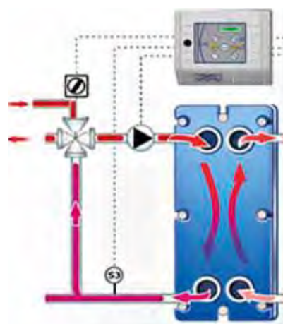
Вариант с 4-ходовым клапаном
