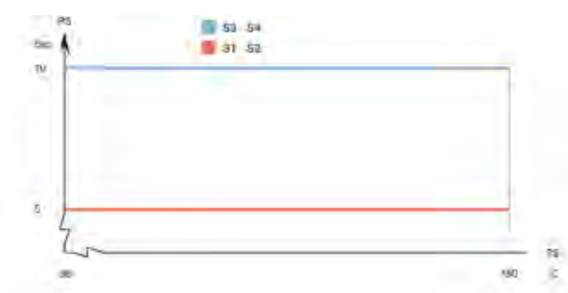
Диаграмма “давление–температура” (каналы Н, А ) для модели СВ18 (соответствует нормативам PED)
