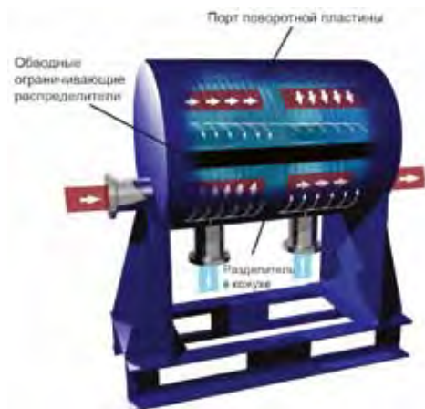
Схема течения теплоносителей в многоходовом теплообменнике AlfaDisc.
