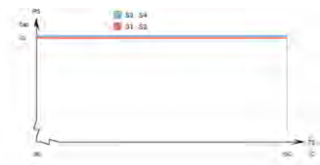
Диаграмма “давление–температура” (канал Н) для модели СВН18 (соответствует нормативам PED)
